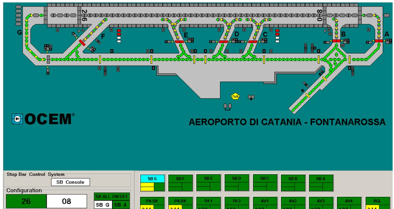
Figura B-15 - Aeroporto di Catania - Sistema Stop Bar - Visualizzazione sul monitor (AGL Console) della modalità con “porta aperta” della barra d’arresto Golf
