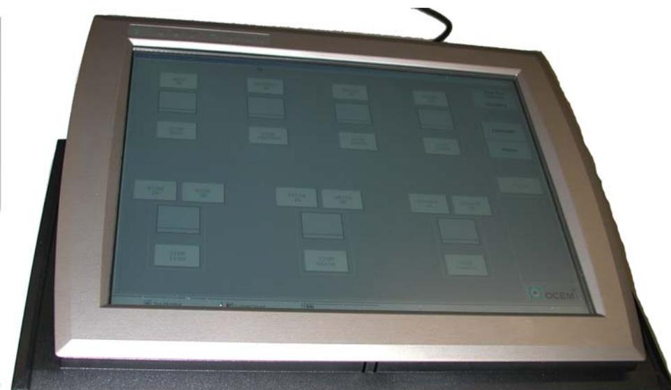
Figura B-21 - Aeroporto di Catania - Sistema di controllo computerizzato - Tasto SB Console per l'abilitazione al comando dalla Postazione Stop Bar System Control
